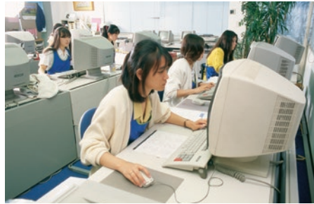
DTPの走りといえるJ-Star。社内LANで結びデータ の共有を行うもテキストデータしか扱えず、画像は 出力後に手動で貼り込んで対処した
